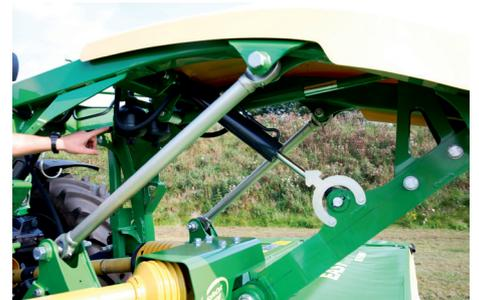
Die Schwingungsdämpfung sorgt für einen idealen Ausgleich bei Unebenheiten.
