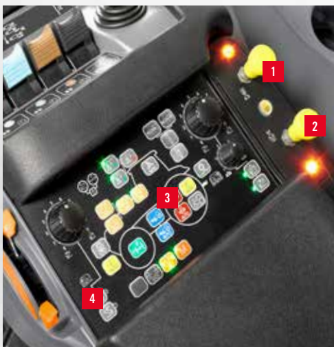
Zapfwellenbetätigung beim Profi und Profi CVT.
