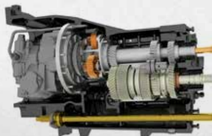
Stufenloses Getriebe von 0 bis 50 km/h
