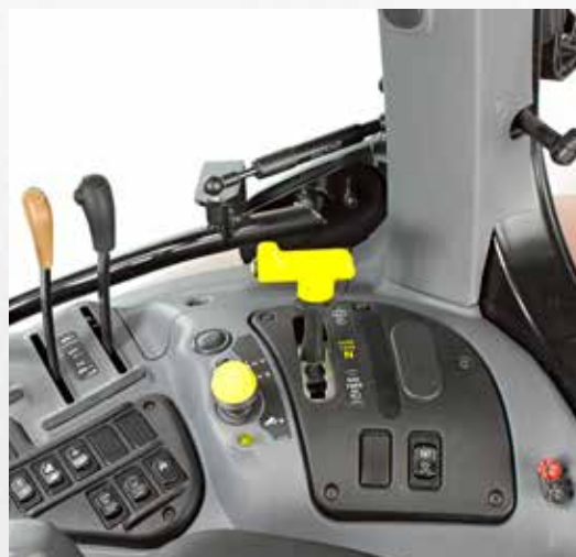
Zapfwellenbetätigung beim Profi Classic.
