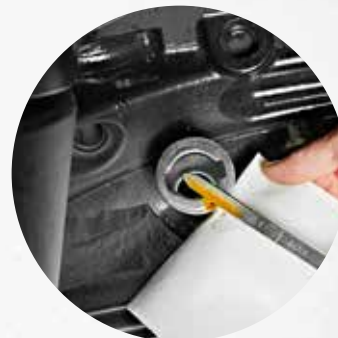
Prüfen des Ölstands und Nachfüllen ohne Anheben der Motorhaube.
