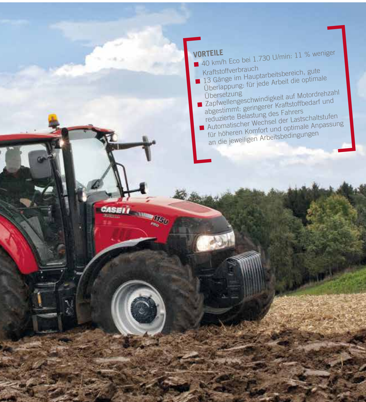
Vier Zapfwellengeschwindigkeiten – 540 / 540 E / 1.000 / 1.000 E
