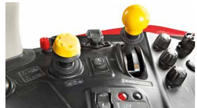
Vier Zapfwellengeschwindigkeiten – 540 / 540 E / 1.000 / 1.000 E
